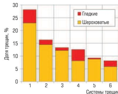
Рис. 8. Распределение трещин по системам и доля шероховатых и гладких трещин в них
